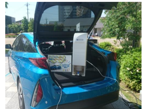
EV・PHVから給電を行い、実際に製品を稼働させて現地で飲料水を生成
